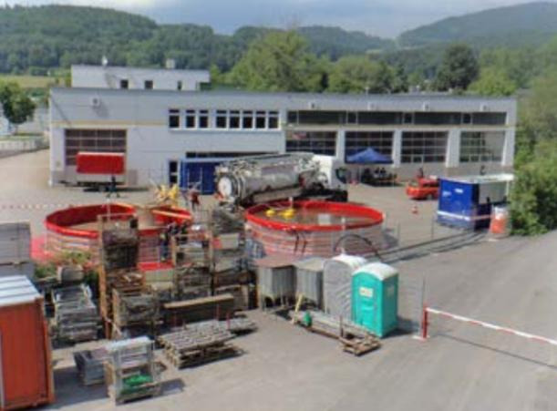
nach angefallener Menge, sowohl durchsichtige IBCs als auch 5 m<sup>3</sup>-, 10m<sup>3</sup>-oder 50 m<sup>3</sup>-Behälter, die gemäß Ölwehrkonzept-Bayern auf den »Geräteanhängern Ölentorgung« und den Abrollbehältern der Ölwehr-Kontingente vorgehalten werden, genutzt werden.
