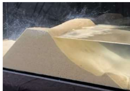
Abbildung 5: Dynamisches Modell zur Simulation von Deichschäden
