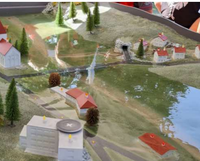
Abbildung 4: Flussmodell zur Überprüfung der erstellten Einsatzpläne mittels Simulation eines Hochwassers
