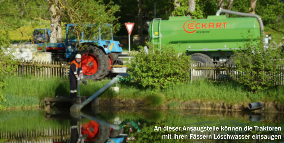
Das Löschfass fasst 6.000 l Wasser und dient zur Erstversorgung mit Löschwasser an der Einsatzstelle
