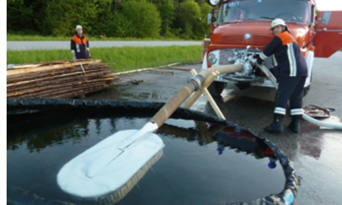
Das Löschfass fasst 6.000 l Wasser und dient zur Erstversorgung mit Löschwasser an der Einsatzstelle
