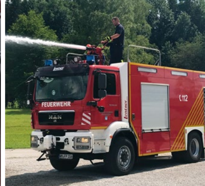
Der Umgang mit dem Dachmonitor auf dem Tanklöschfahrzeug mit Sonderlöschmittel (TLF 20/40 SL) macht besonders Spaß.
