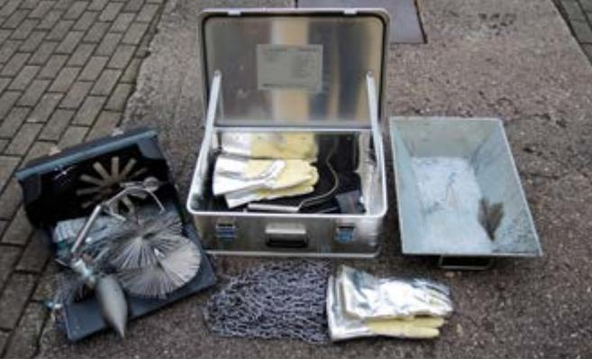
Werkzeugsatz »Schornsteinfeger« nach DIN 14800-4 inkl. Schuttmulde für die Reinigung an der oberen und unteren Reinigungsöffnung
